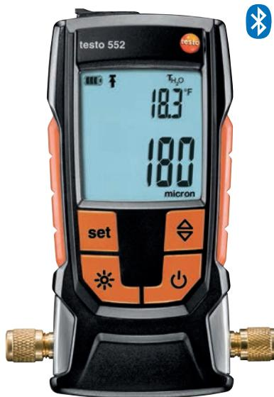
testo 552 是一款数字式真空表，适用于制冷及热泵系统的真密度检测。除此之外，用户还能精确判断系统的除湿程度及杂质的去除程度（例如：油，杂质气体等）。
