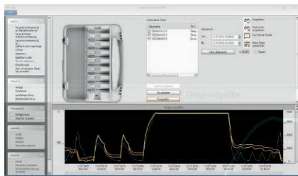
通过直观的testo 190 CFR软件对**数据记录仪进行编程和读取**。数据分析过程不需要数据导出(例如Excel)。一键式报告，意味着只需单击一下鼠标即可得到完整的审计相关文档。当然，其遵从21 CFR Part 11的要求。在一个验证过程中，最多可以对254个数据记录仪进行数据的读取。
