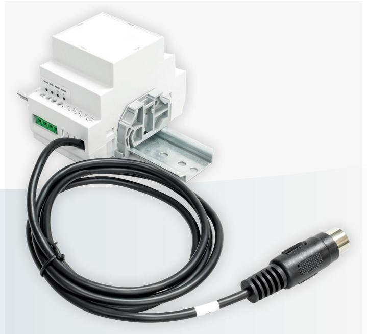
testo 350 Modbus适配器用于协助testo 350烟气分析仪嵌入自动化控制系统。用户可通过任意工业软件操控testo 350进行现场测量，并远程读取测量数据和错误信息。适配器通讯连接非常简单：先将Modbus适配器标配电缆线与testo 350底部对应接口连接，再用信号线将适配器连接至TCP或4G网关的RS485端口，然后通过简单的网关配置即可建立通讯。
