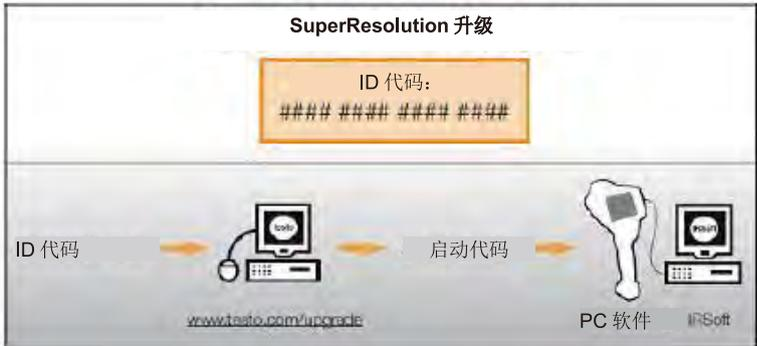
您将会收到一个信封，上面有登录代码（**身份代码**），您需要在登录网址：[www.testo.com/upgrade](http://www.testo.com/upgrade) 时输入该代码。当所有必要数据都已经输入之后，将会生成一个**启动代码**，并且它可以用来通过 PC 软件 IRSoft 来启动功能。请遵守网址上或发送给你的电邮当中的安装要求和步骤。
