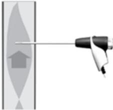
烟气探针端部必须处于烟气流s的中心。
