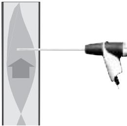
烟气探针端部必须处于烟气流的中心。
